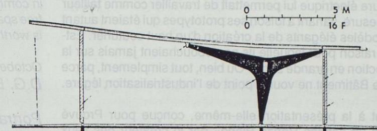
Fig.2. Poutre intermédiaire et détail du noeud
